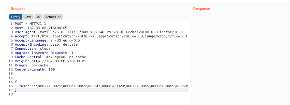
Рисунок 4.13 – Пример обхода WAF зашифрованным запросом
