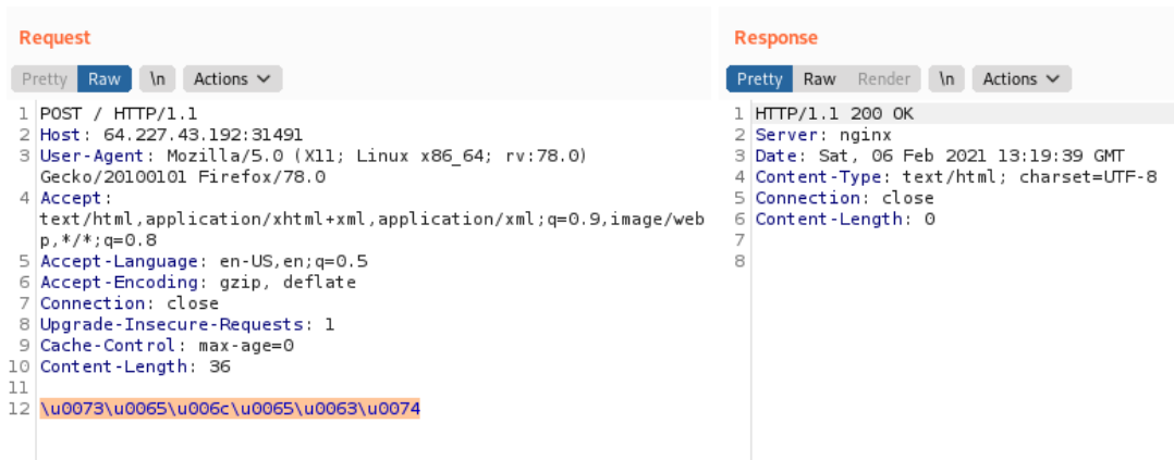
Рисунок 4.12 – Попытка отправить запрос с кодированием параметра
