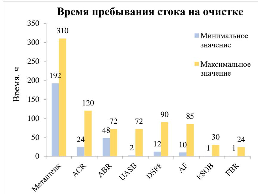
Рисунок ПЗ.4 – Сравнение основных конструкций анаэробных биореакторов по времени пребывания стока на очистке
