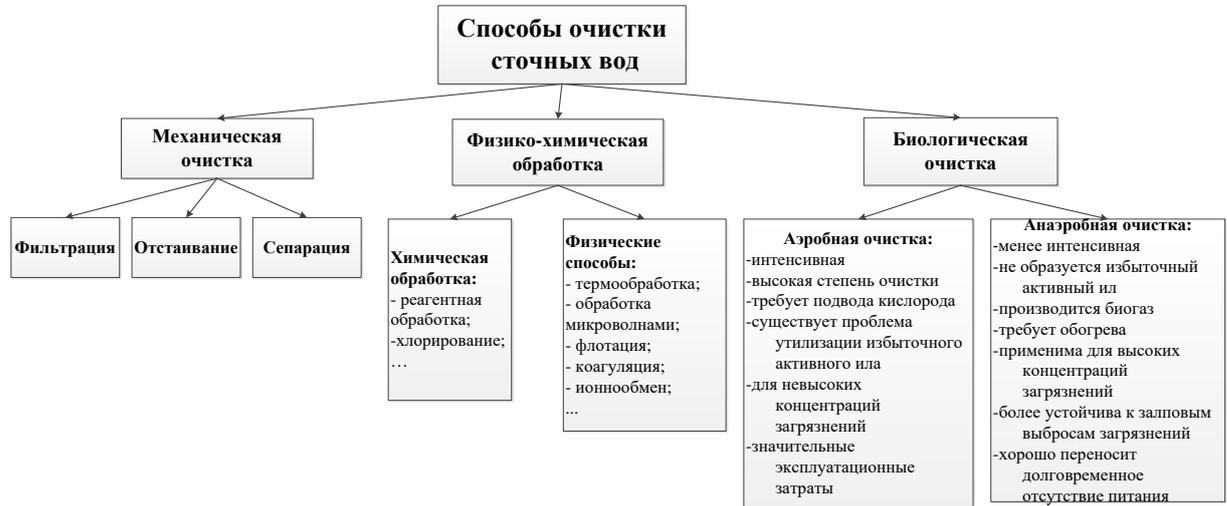
Рисунок 1.2 – Способы очистки сточных вод
