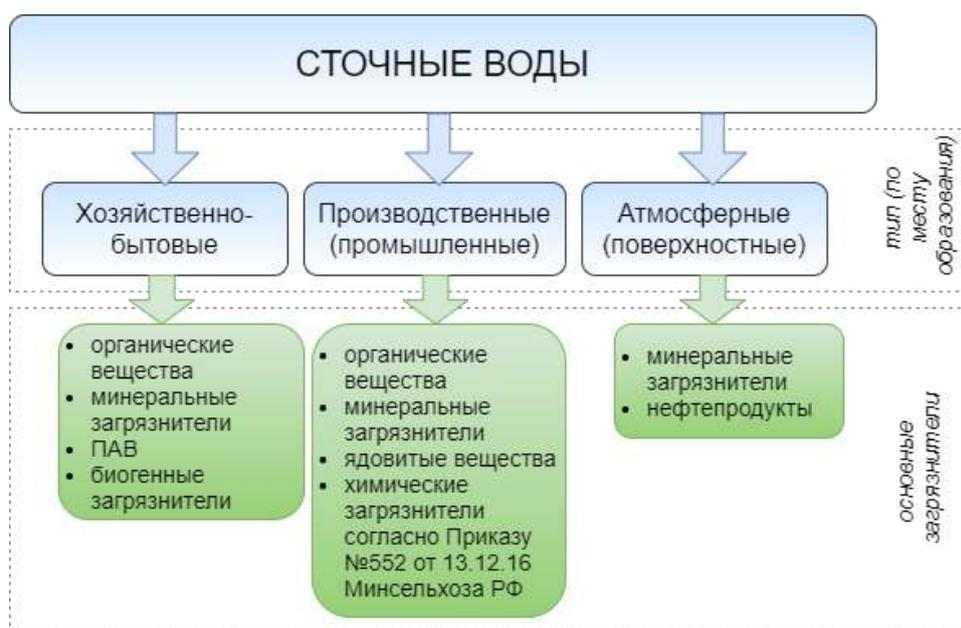
Рисунок 1.1 – Классификация сточных вод
