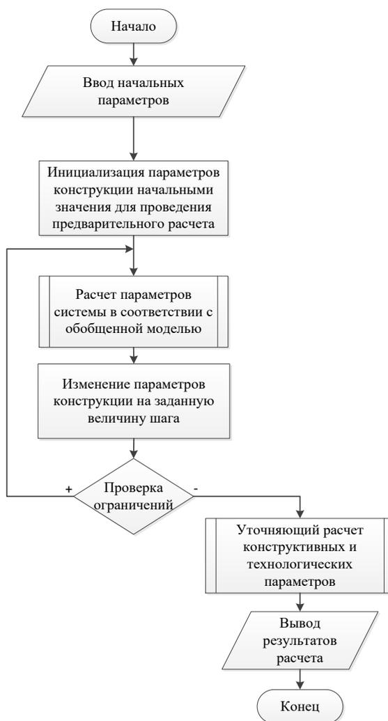
Рисунок П9.1 – Алгоритм проектирования анаэробного биореактора
