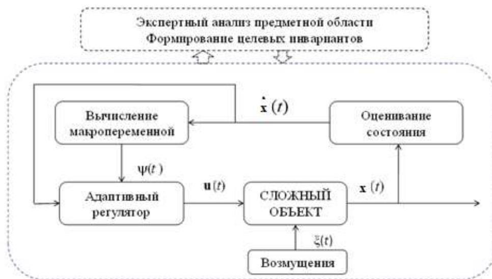
Рисунок 1.10 – Структурная схема системы адаптивного управления
