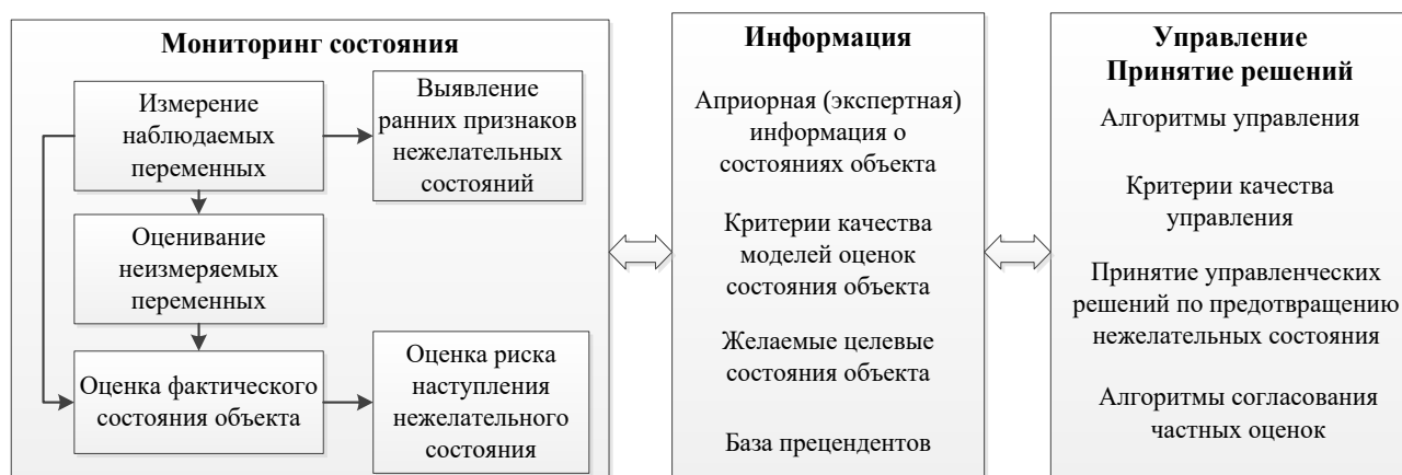
Рисунок 1.11 – Структурная схема взаимодействия двух систем: мониторинга обобщенного состояния САБО и управления
