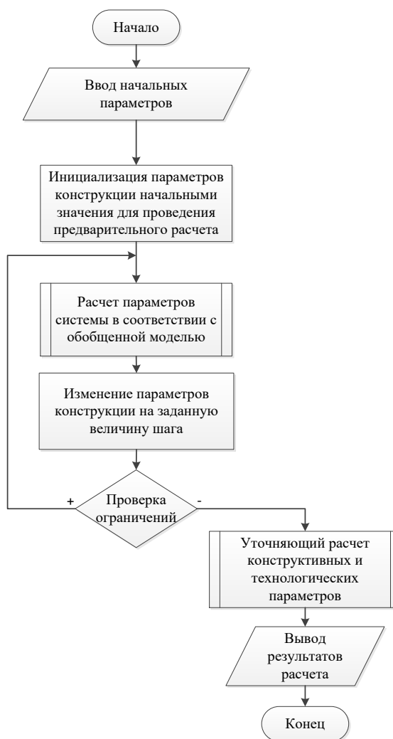
Рисунок П9.1 – Алгоритм проектирования анаэробного биореактора
