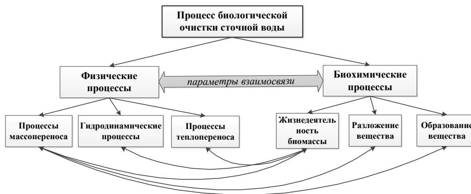
Рисунок П2.1 – Основные процессы в системе анаэробной биологической очистки сточной воды
