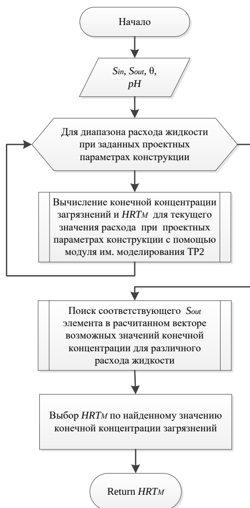
Рисунок П8.1 – Алгоритм расчета HRT_M по измеренным параметрам процесса анаэробного брожения
