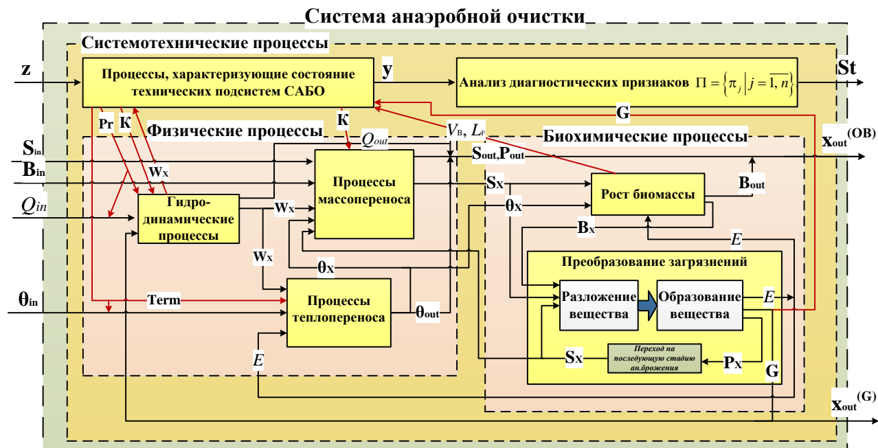
Рисунок 2 – Взаимосвязь системотехнических, физических и биохимических процессов в САБО
