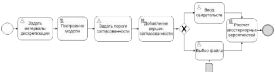
Рисунок 3 — Схема алгоритма оценивания согласованности информации о последних эпизодах и рекордных интервалах пуассоновского процесса в модели оценивания его интенсивности
