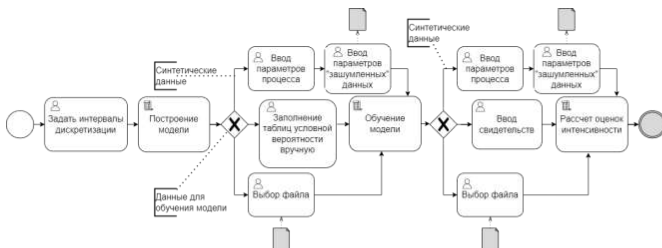
Рисунок 3.11 — Схема алгоритма обработки некорректности информации об эпизодах поведения, полученной от респондентов, при оценивании интенсивности пуассоновского процесса
