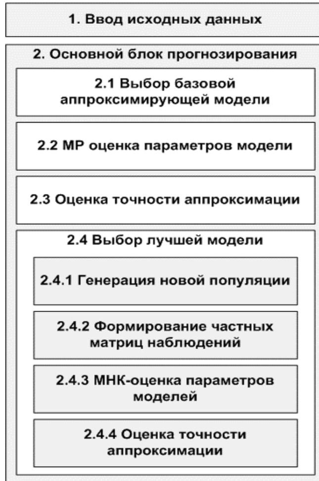
Рис. 2.7. Структурная схема алгоритма прогнозирования на основе гибридного алгоритма
