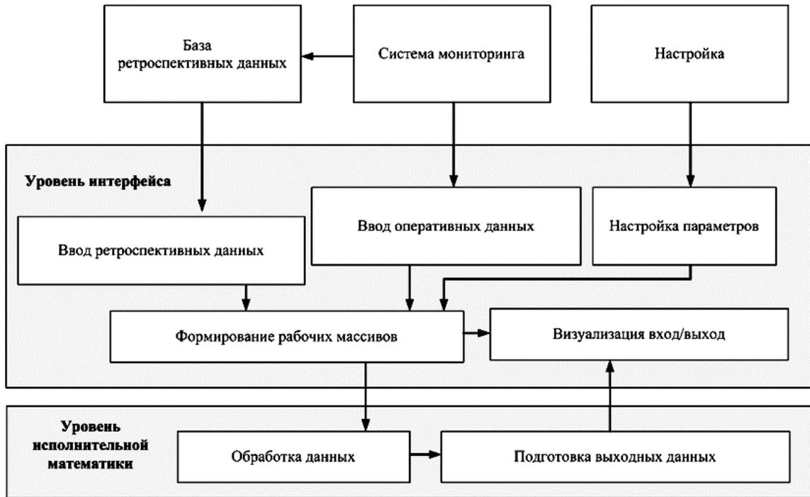
Рис. 4.2. Унифицированная двухуровневая схема программного модуля
