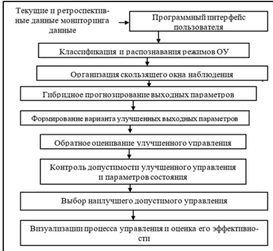
Рис. 3.6. Структура алгоритма проактивного управления с обратным оцениванием параметров управления и состояния
