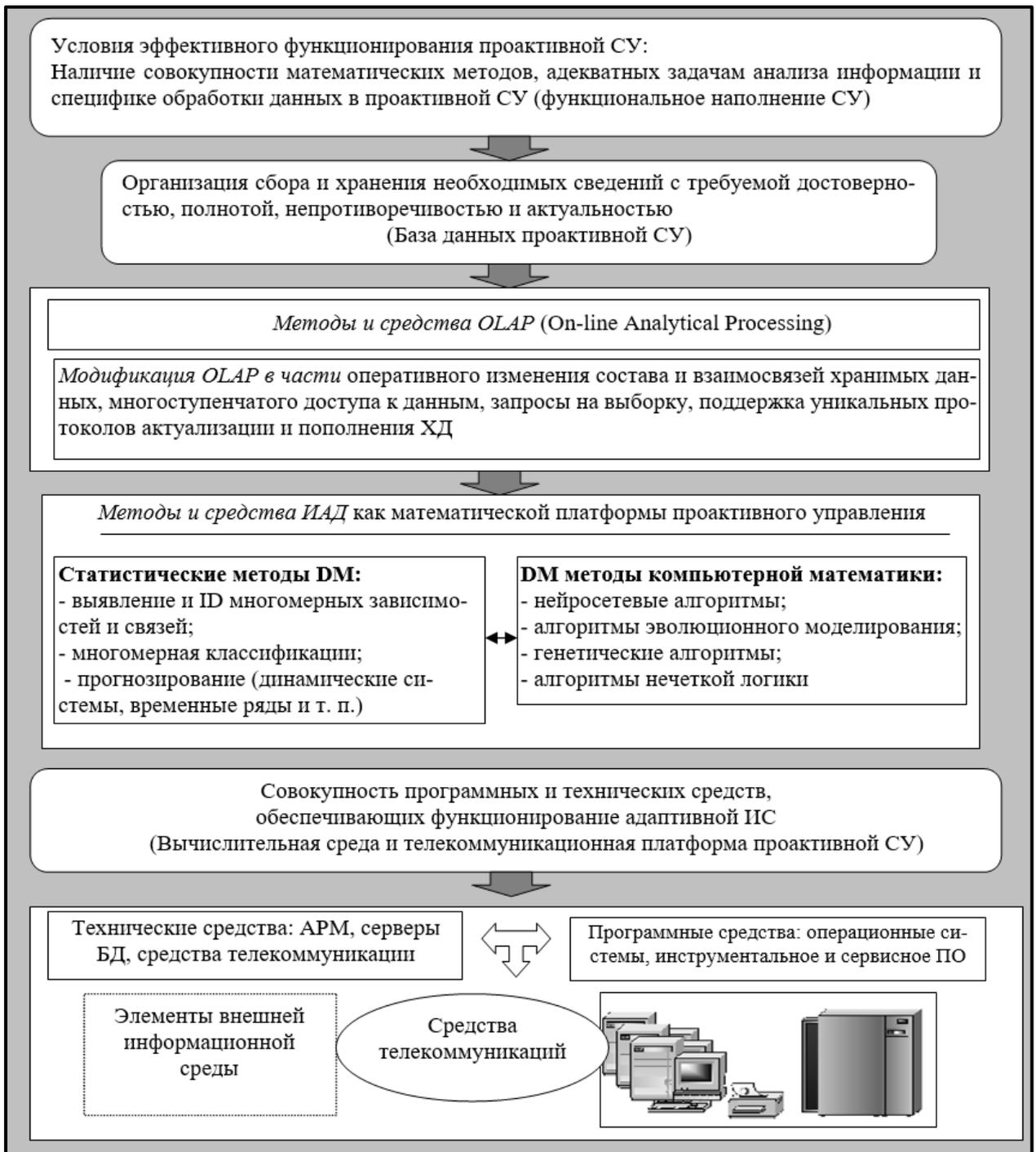
Рис. Е.1. Компоненты информационной платформы проактивной системы управления
