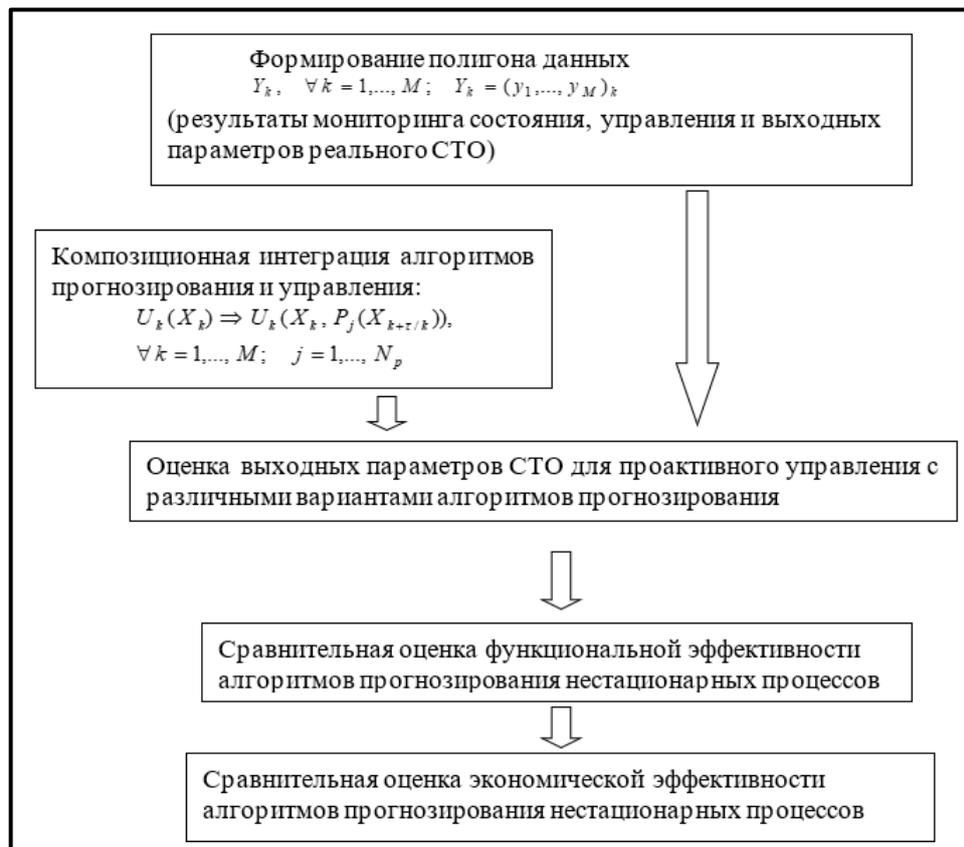
Рис. 3.1. Последовательная схема реализации методики оценки эффективности алгоритмов прогнозирования
