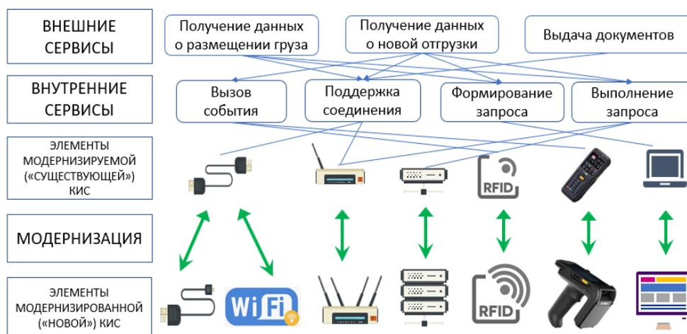
Рисунок 2. Схема взаимосвязи внешних с внутренними сервисами и (опосредованно) с ресурсами КИС на этапе модернизации
