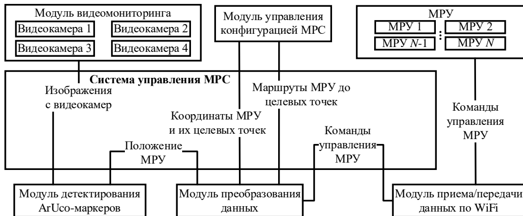
Рисунок 6 – Архитектура комплекса программно-аппаратных средств управления МРС
