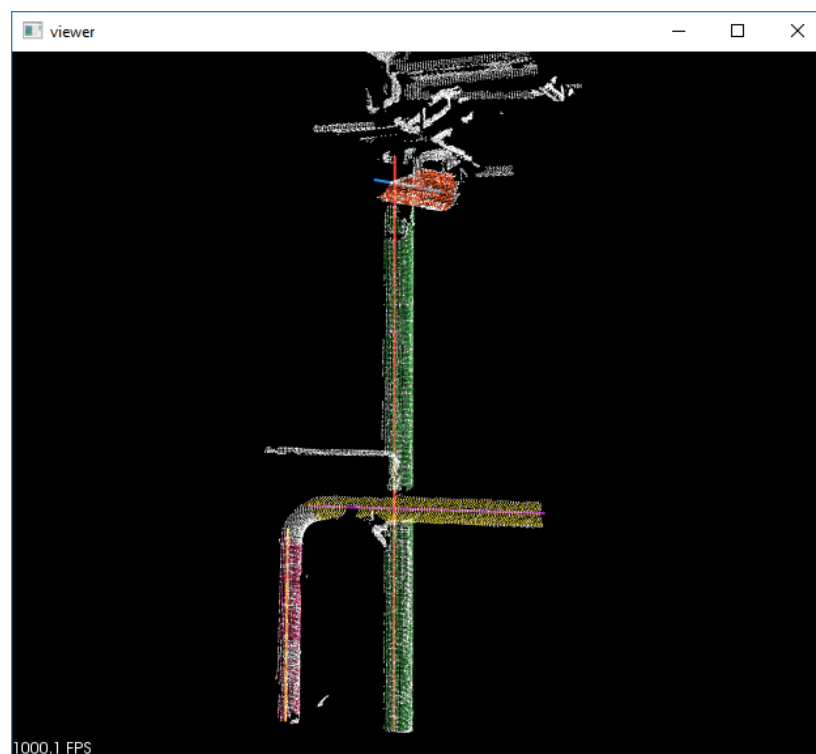
Рисунок 3.10 - Результат работы алгоритма поиска цилиндрических поверхностей
