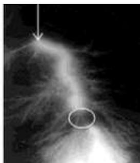
Рисунок 3.5 – Траектория разряда при наличии проводящих включений [67]
