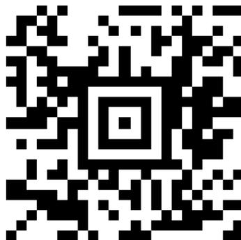
Рисунок 3.11 – Пример двумерного штрихкода Aztec code [22]
