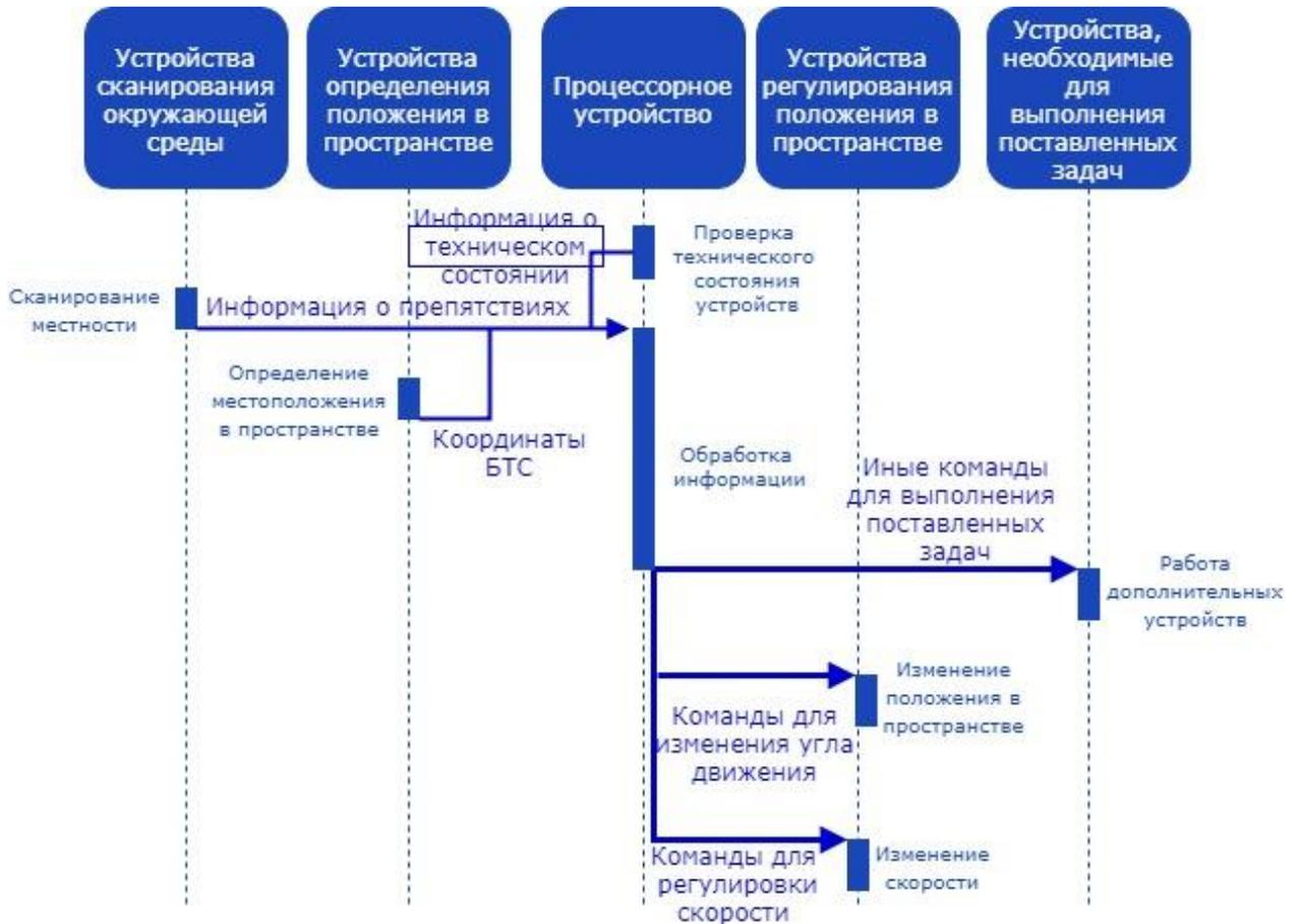
Рисунок 6. Диаграмма внутреннего ИВ BTS в процессе функционирования
