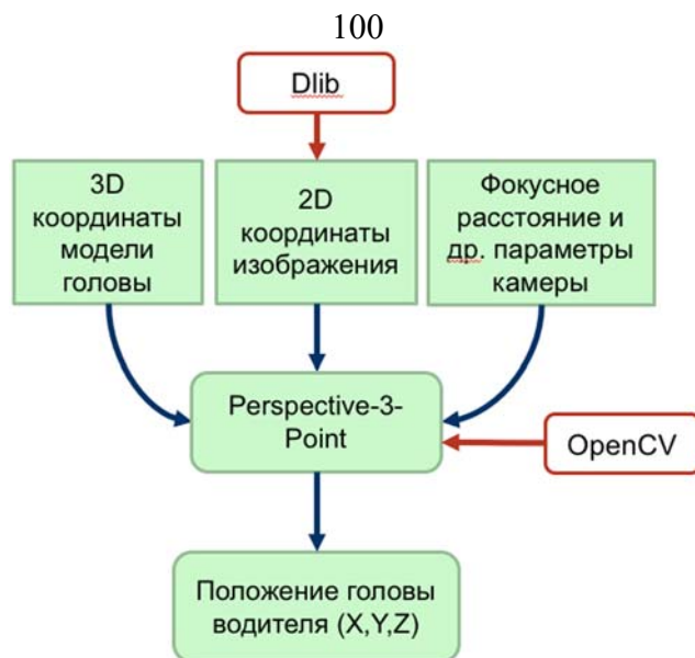
Рисунок 16 – Схема определения положения головы водителя
