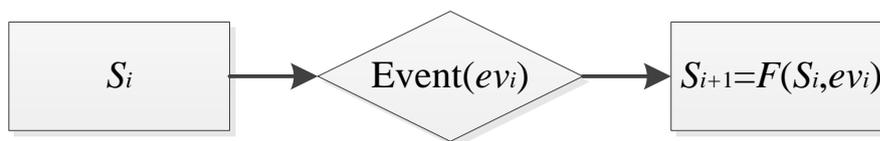
Рисунок 16 – Изменение состояния системы в результате поступления события
