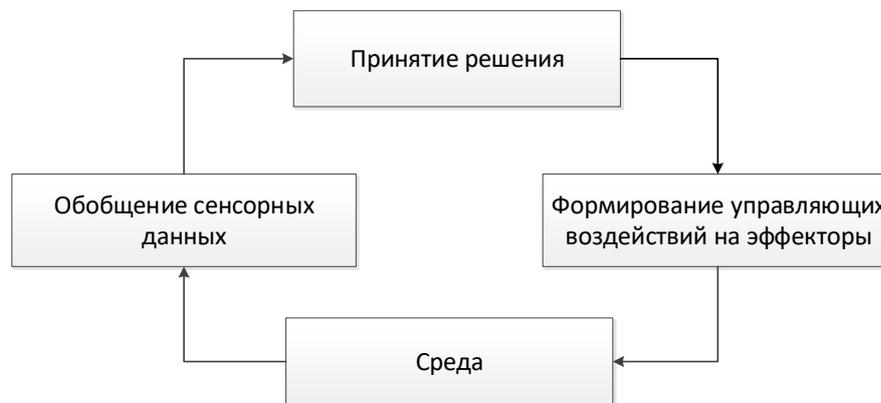
Рисунок 1.1 – Общий вид замкнутой нейроморфной системы
