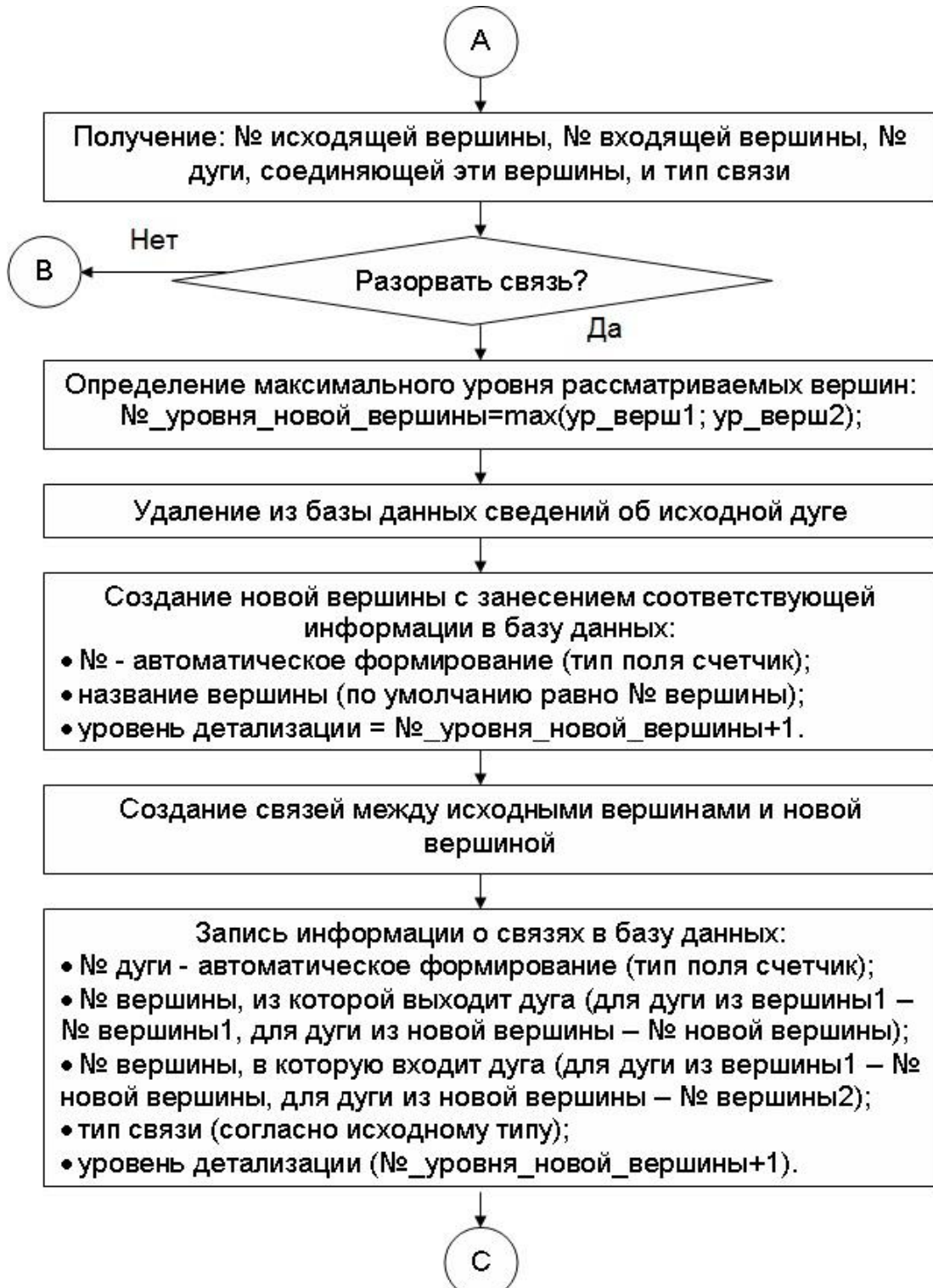
Рисунок 13 - Фрагмент блок-схемы, отражающий алгоритм разрыва связи
