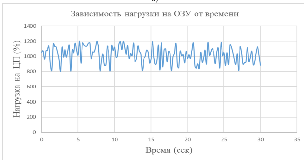
Рис. 4.6. Зависимость потребляемых ресурсов центрального процессора и оперативной памяти от времени при 100 клиентах
