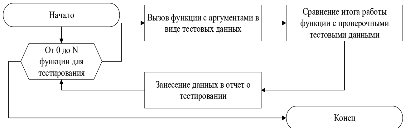
Рис. 4.2. Общий алгоритм функционального тестирования логики работы клиентской и серверной частей приложения
