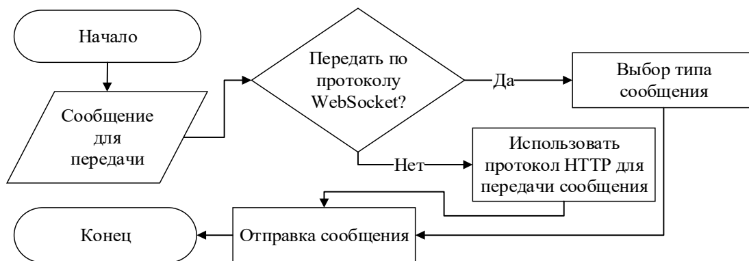
Рис. 2.8. Алгоритм передачи данных между сервером и клиентом
