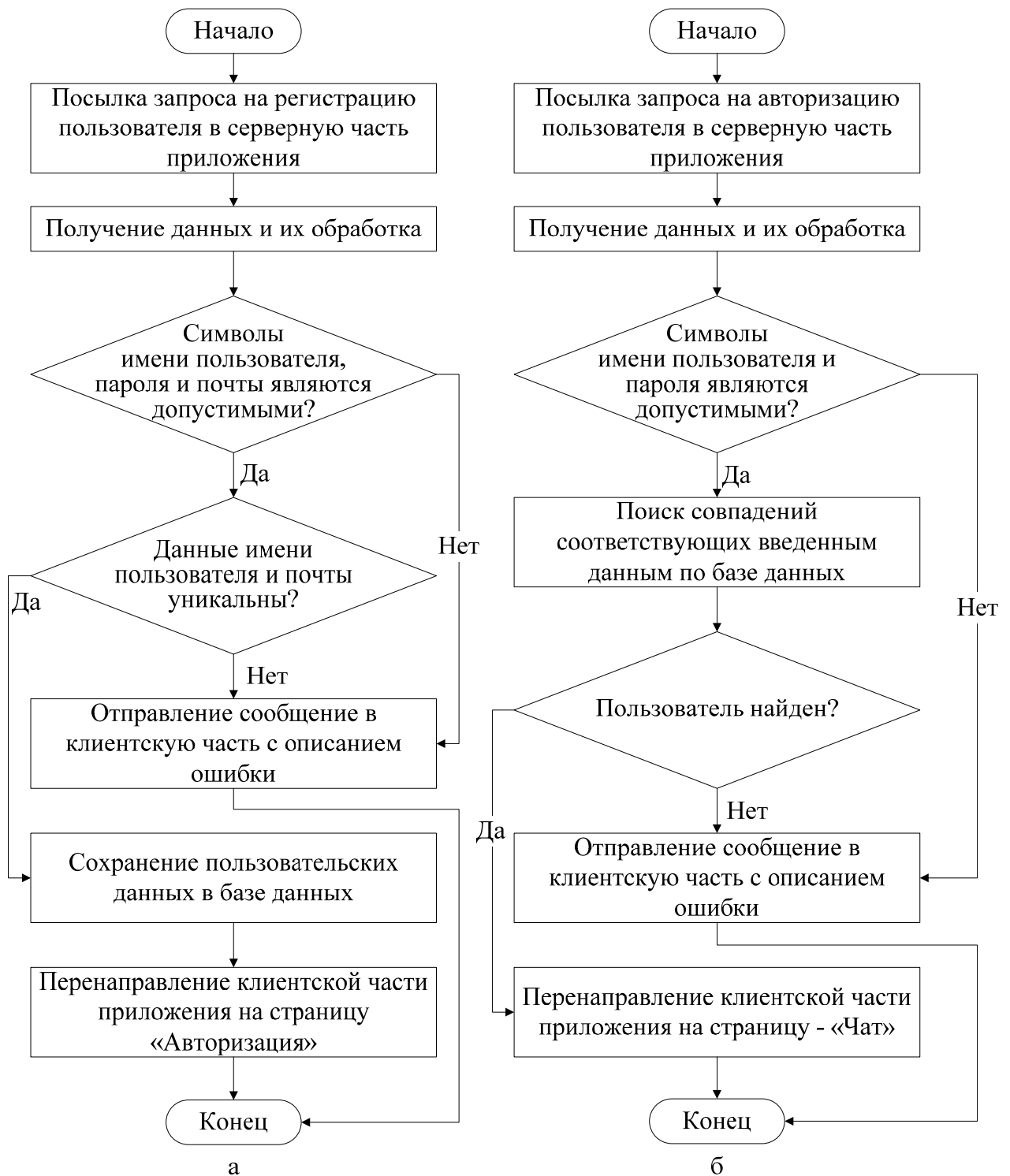
Рис. 2.15. а) Алгоритм регистрации пользователя; б) Алгоритм авторизации пользователя
