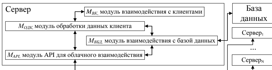
Рис. 2. Архитектура серверной части приложения видеоконференцсвязи
