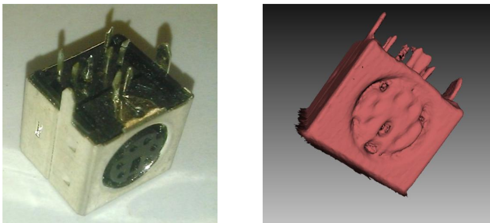
Рисунок 4.7 – Отсутствие мелких отверстий. Слева – фотография объекта, справа – визуализация цифрового скана
