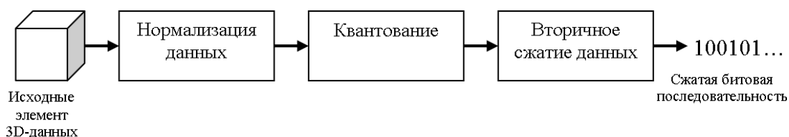
Рисунок 2.7 – Последовательность компрессии томографических данных
