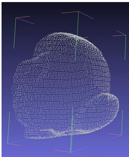
Рисунок 1.13 – Представление трехмерного объекта в виде облака точек
