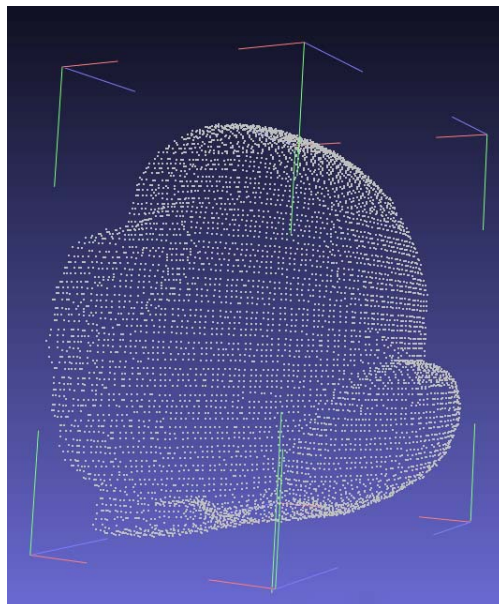
Рисунок 1.13 – Представление трехмерного объекта в виде облака точек
