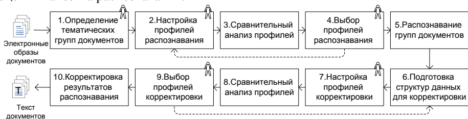
Рис. 3. Технология распознавания архивных документов и корректировки результатов (фигурой человека обозначены этапы, выполняемые с участием эксперта)
