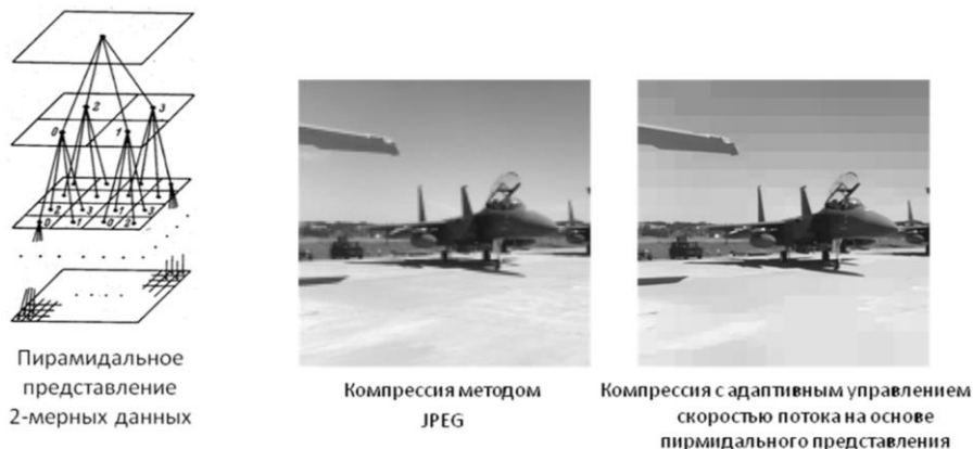
Рис. 2. Иллюстрация использования пирамидального подхода к динамическому управлению компрессией видеоданных
